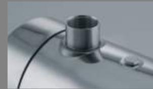
Motorgehäuse mit Druckstutzen
